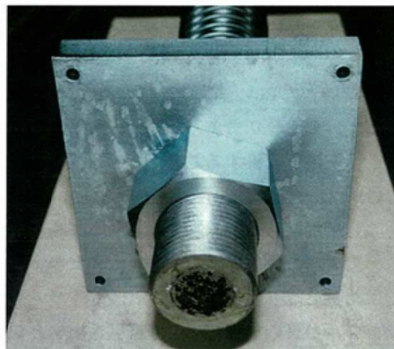
写真 1-3 アンカープレートの前面
