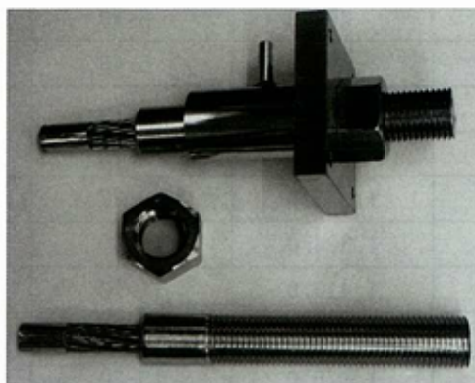
写真 1-1 定着部の組立てナット(中)、マンション(下)
